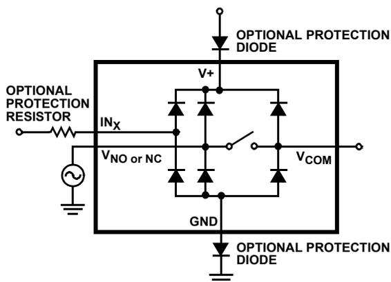
FIGURE 8. OVERVOLTAGE PROTECTION
